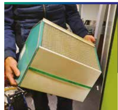
Echangeur de la VMC double-flux de la tour tri-fonctions
